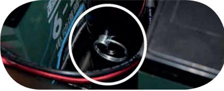
Retire el asiento como se describió anteriormente. Desenrosque el tornillo de bloqueo del marco y ajuste el asiento a la altura deseada. Vuelva a colocar el tornillo de bloqueo. Vuelva a colocar el asiento como se describe anteriormente en la sección de extracción del asiento.
