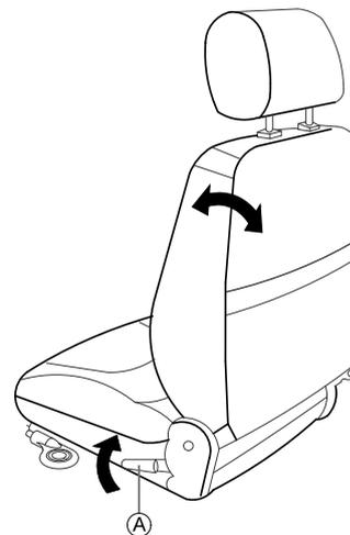
1. Tire de la palanca y ajuste el ángulo del respaldo según desee, inclinándose hacia delante o hacia atrás.
