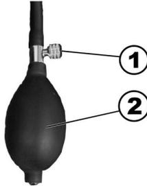
1. Compruebe que el tornillo del tubo de aire (1) está totalmente cerrado hacia la derecha.
