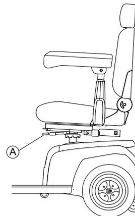
Tire hacia arriba de la palanca de freno **A**.
