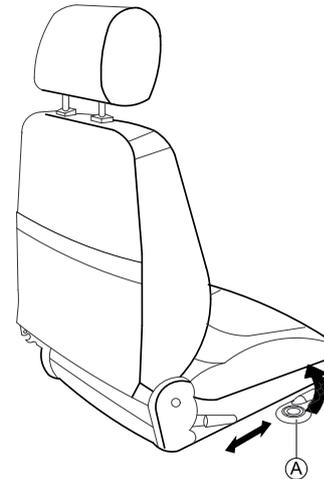
1. Tire de la palanca **A** para desacoplar el asiento.
