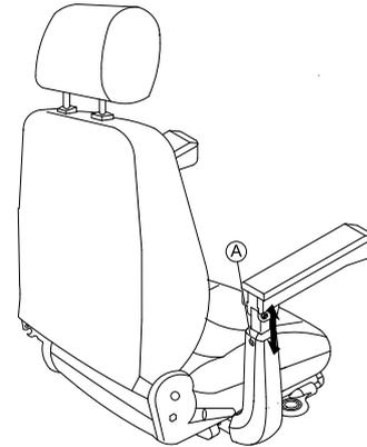
1. Afloje y retire el tornillo de fijación del reposabrazos Ⓐ.
