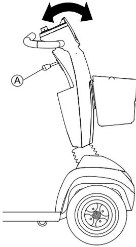
1. Presione la palanca **A** hacia abajo para ajustar la columna de dirección.
