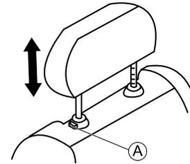
1. Para levantar el reposacabezas, pulse el botón de desbloqueo (A) y suba el reposacabezas hasta alcanzar la posición que desee.
