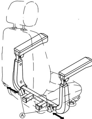
1. Gire los tornillos Ⓐ para aflojar la fijación del reposabrazos.
