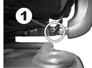
Coloque el tornillo (1), enrosque la tuerca desde el otro lado y apriete mediante una llave inglesa.
