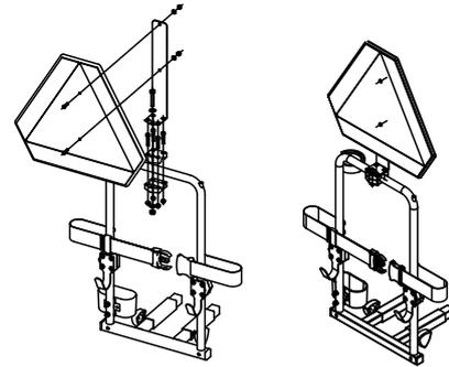
1. Coloque el reflector trasero como se muestra en la ilustración.
