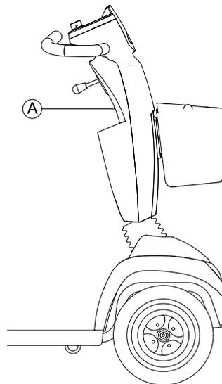
El interruptor basculante **A** para ajustar el elevador del asiento se encuentra en la columna de dirección.
