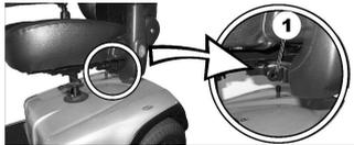
Los soportes de montaje (1) para fijar el cinturón se encuentran debajo del asiento (la ilustración solo muestra el lado izquierdo).
