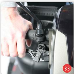
Das Parken und Feststellen der Bremse erfolgt durch Verriegeln des Antriebs. Dazu ist der Scooter durch eine Hilfsperson und/oder durch den Einsatz der manuellen Betriebsbremse zum Stehen zu bringen. Im Stillstand kann der Antrieb wieder eingekoppelt werden (Abb. 31).
