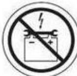
Mantenga las herramientas y otros objetos metálicos alejados de los terminales de las baterías. Si toca los terminales de las baterías con alguna herramienta puede sufrir una descarga eléctrica. No se sienta en el Breeze S cuando se encuentre en cualquier tipo de elevador.
