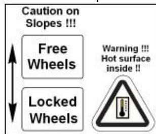
No suelte el freno manual o la palanca de liberación del freno electromagnético (EMB), cuando el Breeze S esté en una pendiente. Cuando esté en un plano inclinado, nunca coloque el Breeze S en modo manual mientras está sentado o de pie junto a él.
