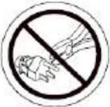
La eliminación de la toma a tierra puede crear riesgo eléctrico. Si es necesario utilizar una toma de corriente de 3 puntas, instale un adaptador de 2 puntas homologado.
