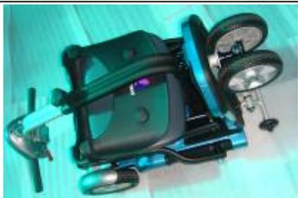
Doble hacia abajo la palanca de dirección para plegar el scooter.
