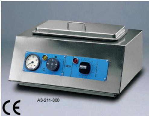
Resistencias de acero inoxidable. Reloj regulable hasta 120 minutos, cuando el tiempo ha terminado el reloj apaga automáticamente el aparato. Termómetro sonda de 0 a 200°C con termostato de seguridad. Piloto rojo para indicar la alimentación y pilotos verdes para indicar que las resistencias están funcionando.
