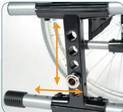
Diseño abierto de armazón que permite un ajuste en profundidad de 41-46 cm, ajuste en altura de las ruedas traseras y del centro de gravedad (+5 a -5 cm).
