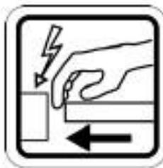
Esta señal marca los lugares donde hay un peligro de pillarse los dedos u otras partes del cuerpo. La parte delantera donde encaja el manillar es una zona así. Tenga cuidado cuando esté montando o desmontando el scooter ya que hay peligro de pillarse los dedos.
