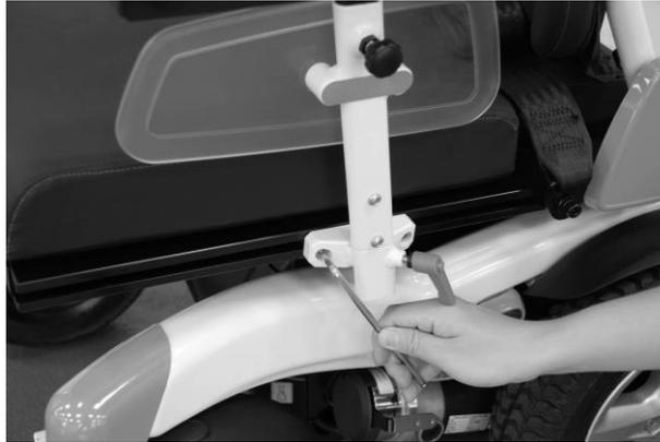
1. Use una llave Allen, afloje las tuercas laterales del reposabrazos y deslícelo hacia adelante o hacia atrás hasta alcanzar la posición deseada.
