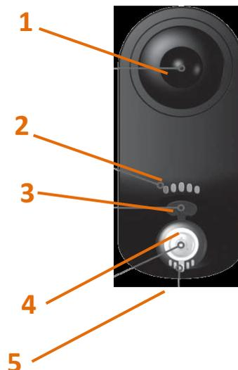
En la parte frontal tiene el puerto para conectar el cargador.
