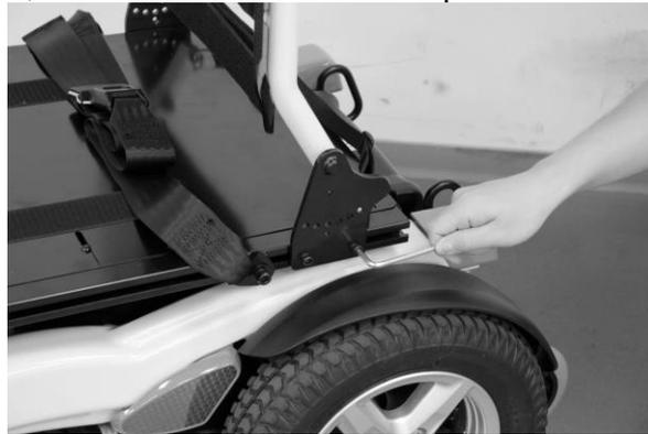
Afloje los dos tornillos, y luego ajuste el cinturón de seguridad en la posición deseada, los dos lados al mismo tiempo.
