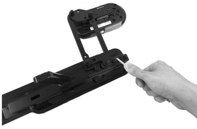
1. Mediante los tornillos inferiores regule la distancia del joystick.
