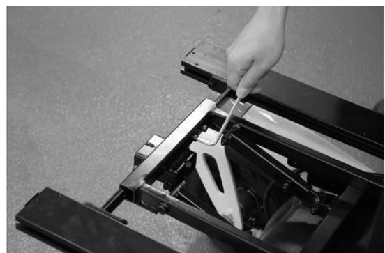
Extraiga los tornillos delanteros y traseros de la parte inferior del asiento. Deslice los laterales a la posición adecuada y fije de nuevo los tornillos. Haga lo mismo con la parte trasera.
