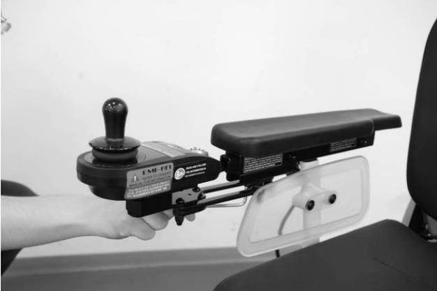
Paso 5 inserte el cable del Joystick en el cable negro de la caja delantera de las baterías. Enchufe el conector eléctrico y el conector del controlador.
