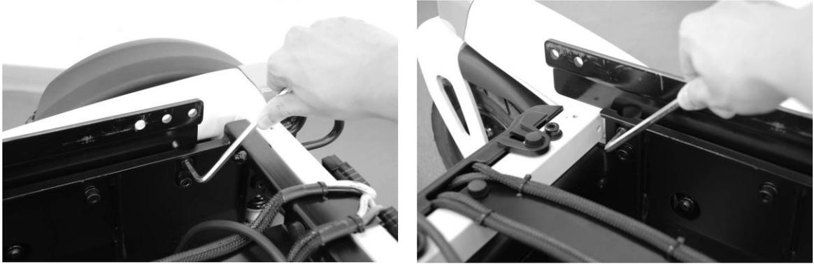
Extraiga los 8 tornillos interiores. Ajuste la altura deseada y vuelva a fijar los tornillos.
