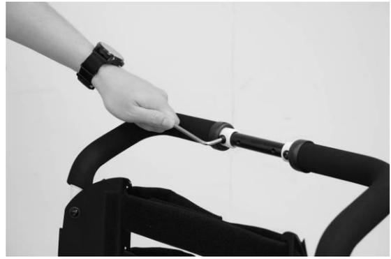
Afloje los tornillos delanteros y traseros de la barra de empuñadura.
