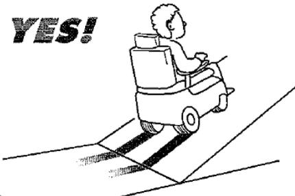
**Suba o descienda siempre las pendientes perpendicularmente a la inclinación de la rampa.**
