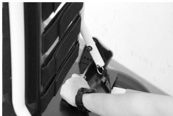
Afloje los cuatro tornillos, y luego ajustar el eje del respaldo lzq. / Der a la posición deseada, los dos lados al mismo tiempo.
