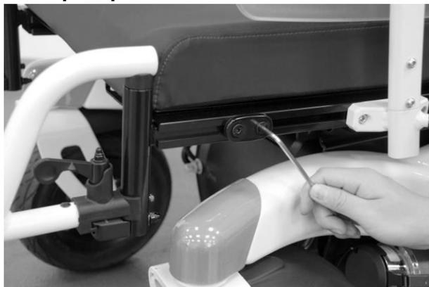
1. Use una llave Allen, afloje las tuercas laterales del asiento y deslice el reposapiés hacia adelante o hacia atrás hasta alcanzar la posición deseada.
